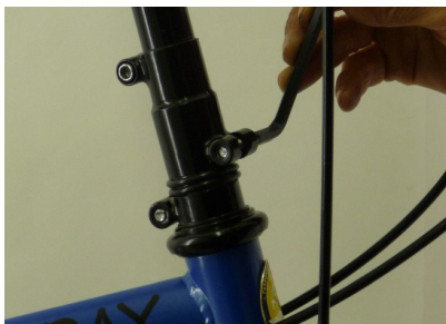
Fig. 41 Remove Stem Riser.
